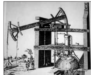
La pompa a fuoco di Thomas Newcomen, realizzata in parti in ghisa ed esportata in tutto il mondo, che permise di aumentare la produzione di carbone del 50%; questa macchina veniva usata esclusivamente al prosciugamento dei pozzi minerari.
