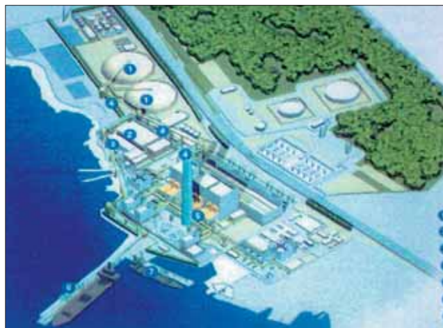
La nuova centrale di Torrevaldalica Nord: 1) carbonili a cupola; 2) deposito gesso; 3) deposito calcare; 4) nastri movimentazione carbone; 5) filtri a manica; 6) banchina per navi carbonifere; 7) banchina per carico e scarico di gesso/calcare.
